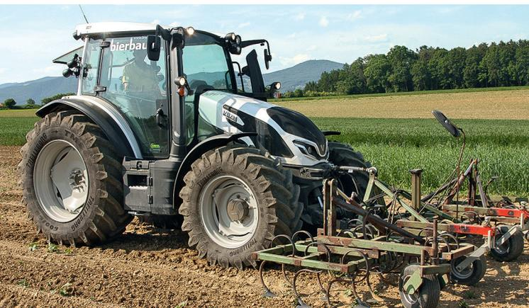
◁ Durch seine schräge Motorhaube sind Frontgeräte ausgezeichnet sichtbar.
