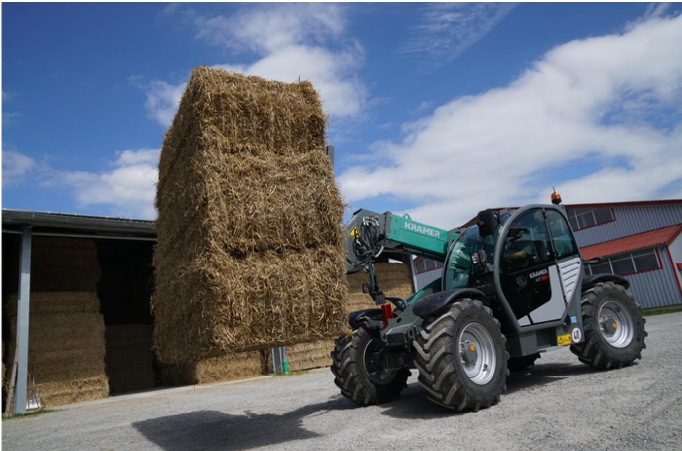
Der Kramer KT357 ist ein wendiger, kompakter und leistungsstarker Teleskoplader, der für landwirtschaftliche Arbeiten konzipiert wurde. Die maximale Hubkraft von 3,5 t und eine Stapelhöhe von 7 m ermöglicht Vielseitigkeit für alle Hof- und Ladetätigkeiten. Die Überlappungsfläche zwischen Innen- und Außenarm > 1m ist ein weiteres Merkmal seiner robusten Bauweise. Sein 136 PS Motor sowie die serienmäßige Load Sensing Ausstattung sorgen für die Leistung die Sie benötigen.
