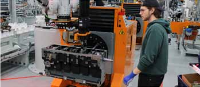
Mechaniker Julius Salmela baut eine Kurbelwelle mit Hilfe eines Industrieroboters ein.
